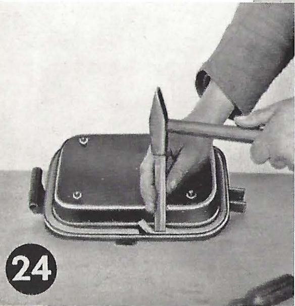
Bild 24. Die eingelegte neue Dichtung wird mit einem Stemmer durch leichte Hammerschläge in der Dichtungsrille, besonders aber am Stoß, festgekeilt.
