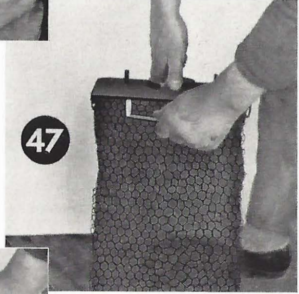
Bild 46. Beim Ausbau der Feinreiniger ist zu beachten, daß die Einsätze nicht verwechselt werden, damit die Dichtungen passend und dicht bleiben.
