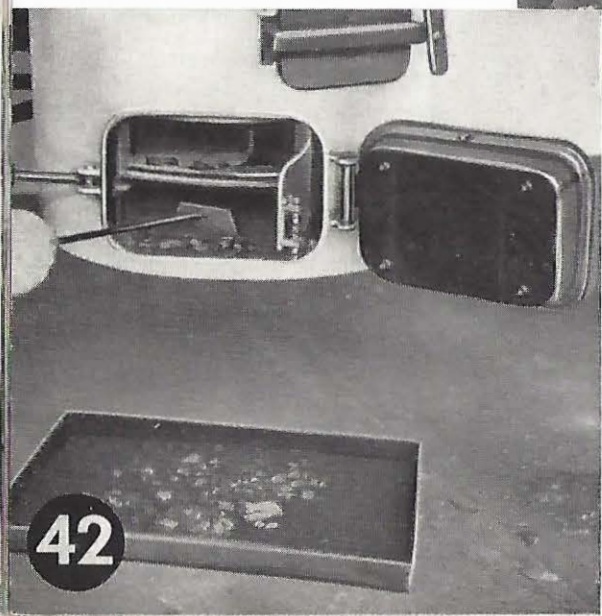
Bild 42. Nach dem Ausräumen werden oben und unten aus dem Gaserzeuger mit einem Kratzer Staub, Asche und Schlacken sorgfältig herausgeholt.
