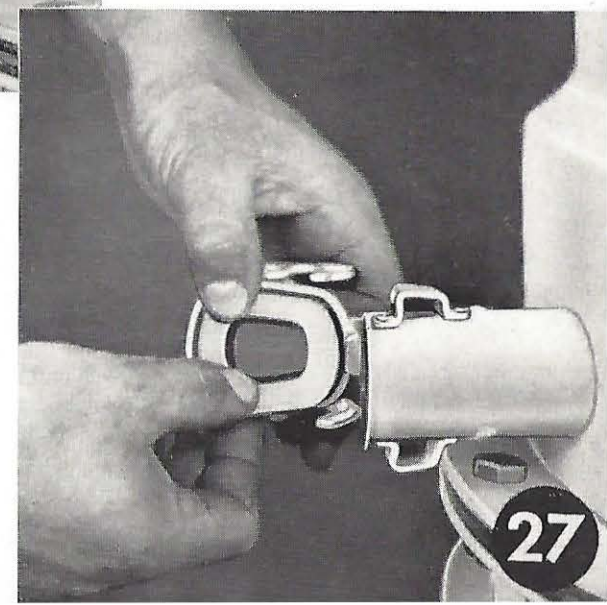
Bild 27. Die neue Dichtung mit den Fingern fest in ihren Sitz eindrücken. Kein Werkzeug verwenden, damit die Dichtungen nicht beschädigt werden.
