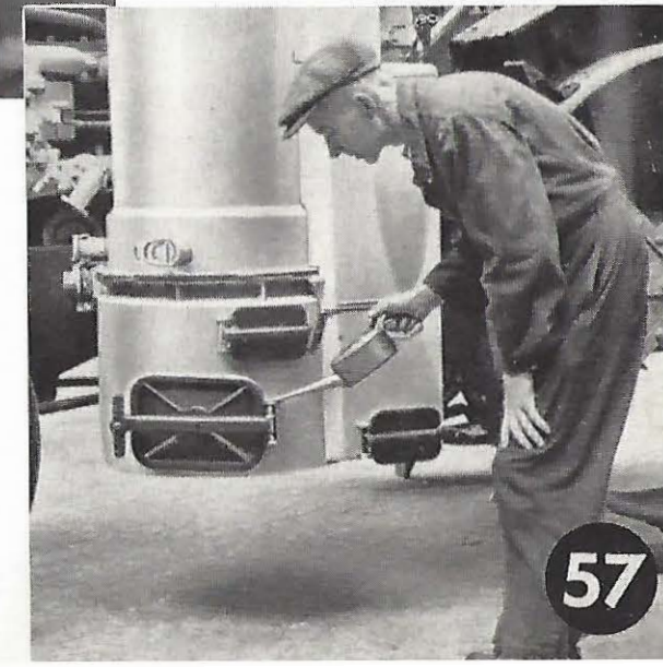
Bild 57. Alle Türscharniere, Schraubverschlüsse und Lagerstellen der Drosselklappen bei der 500-Stunden-Wartung abüben, damit sie leicht gehen.
