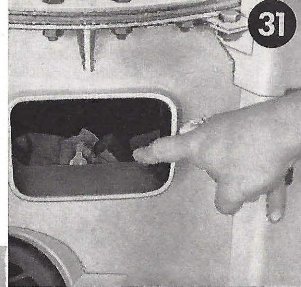
Bild 31. Die Holzkohle muß bis zur Unterkante der Holzkohletür stehen. Weggebrannte Holzkohle ergänzen, überschüssige Holzkohle herausnehmen.
