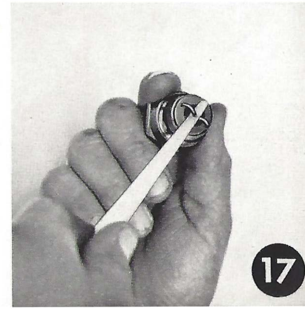
Bild 17. Einstellen des Elektrodenabstandes der Zündkerzen mit der Lehre. Elektrodenabstand 0,4 mm. Elektroden vorsichtig an- und abbiegen.
