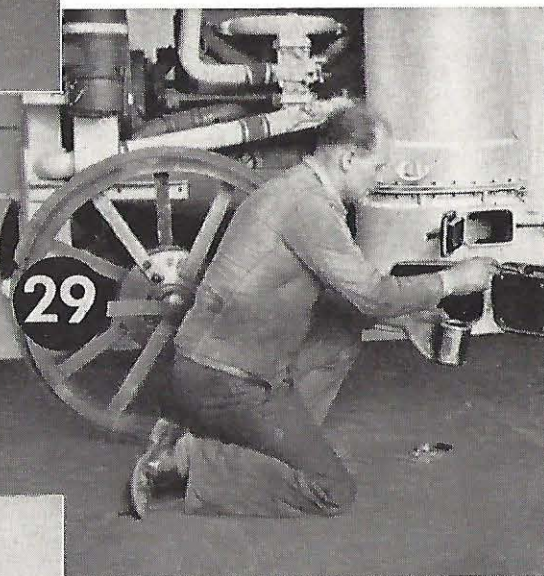
Bild 28. Nach etwa 10maliger Betätigung der Rüttelvorrichtung wird durch die geöffnete Aschetür der Gaserzeuger mit dem Kratzer gründlich entascht.
