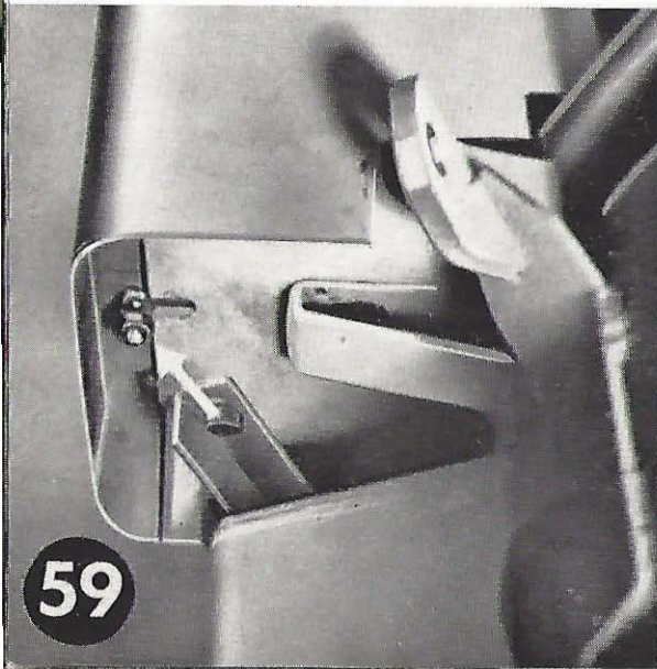
Bild 59. Unten wird die Verkleidung des Wärmeaustauschers von innen mit einer Mutter, auf die im Bild der Pfeil zeigt, am Bodenblech gehalten.
