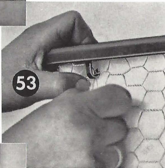
Bild 52. Der neue Glaswattebezug wird vorsichtig übergestreift, damit er sich innen und außen nicht verziehen oder etwa faltig zusammenschieben kann.
