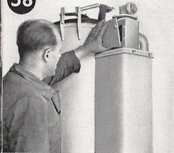
Bild 58. Am Wärmeaustauscher wird der obere Reinigungsdeckel entfernt. Zum Ausbau der Verkleidung die beiden Schrauben oben rechts lösen.
