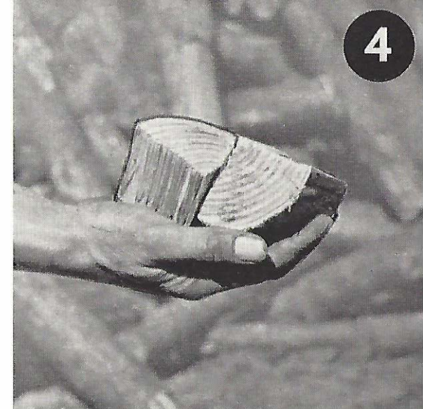
Bild 4. Die Holzstücke auf der Hand zeigen, wie groß das Tankholz sein soll. Rinde kann am Holz bleiben, nur bei Verschmutzung ist sie zu entfernen.
