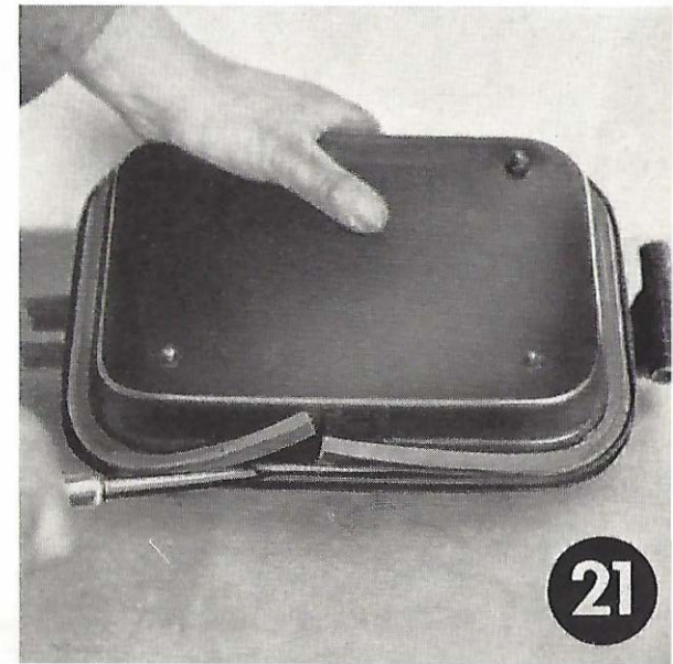
Bild 21. Nach Ausbauen der Tür durch Entfernen des mit einem Kerbstift gesicherten Scharnierbolzens wird die alte Dichtung ringsum ausgehoben.
