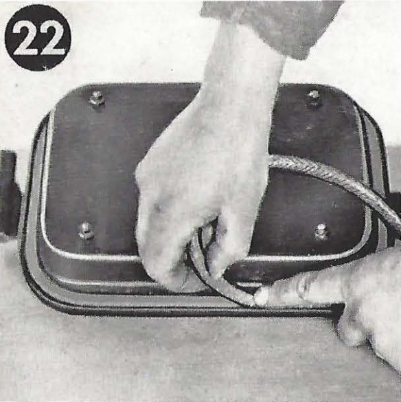
Bild 22. Die graphitirierte Asbestschnur wird in die sorgfältig gereinigte Dichtungsrille eingelegt und die neue Dichtung genau auf Länge abgepaßt.
