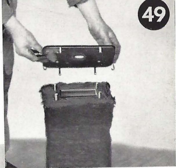
Bild 49. Nach Anhängen des Drahtgeflechtes aus den Haken und nach Abschrauben der vier Muttern läßt sich der Boden des Feinreinigers abheben.
