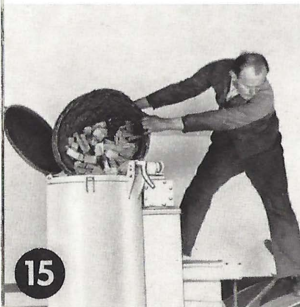
Bild 15. Nach 2—3 Arbeitsstunden muß Brennstoff nachgefüllt werden. Immer mit dem Wind arbeiten: Kopf und Körper weg von der Einfüllöffnung!
