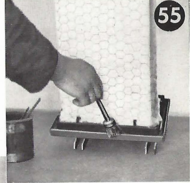
Bild 55. Vor dem Einbau der Feinreinigerinsätze die Asbestdichtungen auf ihren Zustand prüfen und mit Öl-Graphitpaste neu einstreichen.
