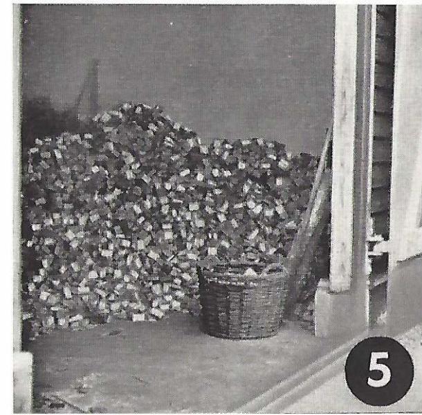
Bild 5. Fertiges Tankholz in einem Schuppen vor Nässe und Verschmutzung geschützt einlagern. Rost unterlegen, damit Luft durchstreichen kann.
