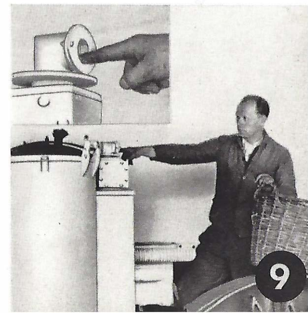
Bild 9. Anschließend an das Füllen wird sofort durch leichtes Anstoßen mit dem Finger die Schnüffelklappe auf einwandfreies Arbeiten geprüft.
