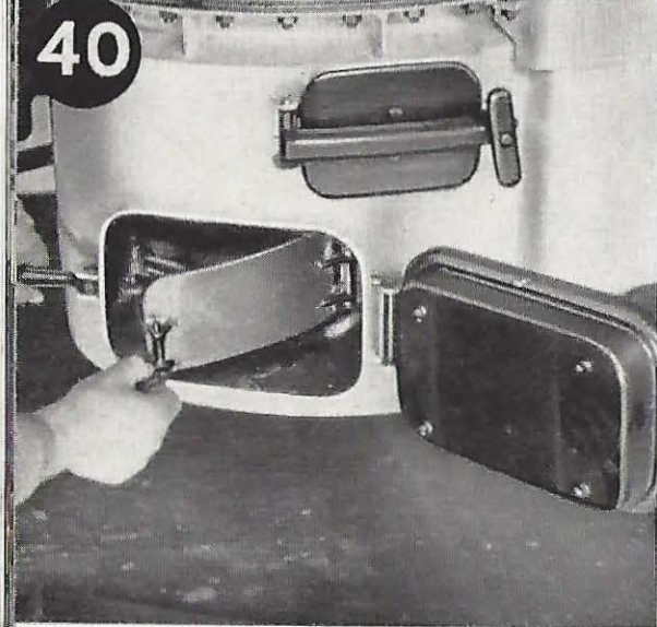
Bild 40. Um den Gaserzeuger vollständig entleeren zu können, werden, wenn das Feuer erloschen ist, die Aschetür und die innere Feuertür geöffnet.
