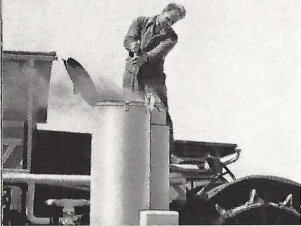
Bild 14. Rechtzeitig Brennstoff nachfüllen. Bei stark heruntergebrannter Füllung das vorgeschwemmte Holz herunterschoben und verteilen.
