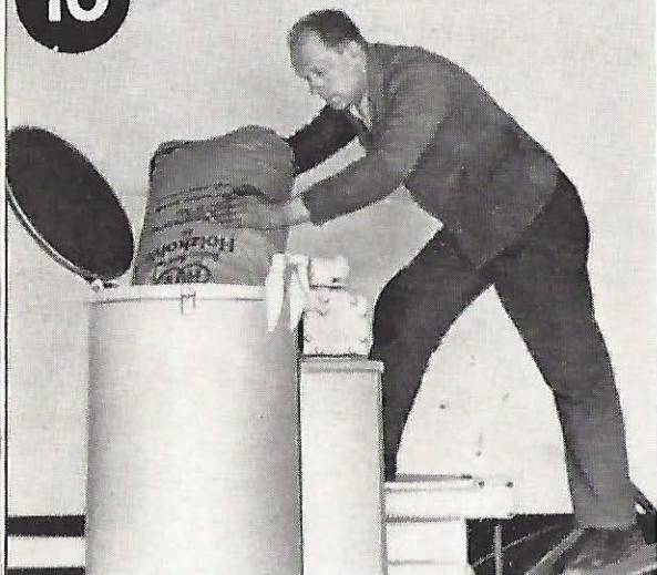
Bild 10. Nur bei Erstbefüllung oder Neufüllung nach völliger Entleerung wird der Gaserzeuger durch die Einfüllöffnung mit Holzkohle beschickt.
