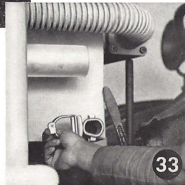
Bild 33. Bei der 60-Stunden-Wartung wird der Wasserablaß am Feinreiniger auf jeden Fall geöffnet, um das etwa angefallene Kondenswasser abzulassen.
