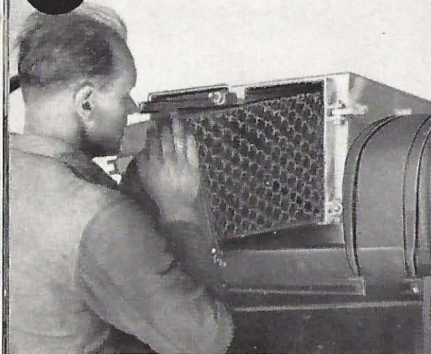
Bild 34. Nach Lösen der Deckelschrauben die Feinreinigereinsätze vorsichtig herausziehen. Bezüge nicht durch Schleifen im Gehäuse beschädigen.
