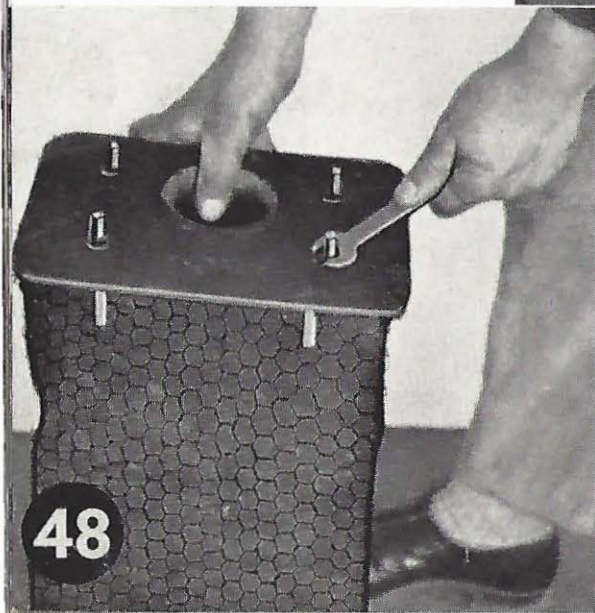
Bild 48. Auf dem Boden des Feinreinigereinsatzes befinden sich vier Muttern, die zum Ausbauen der Glaswattebezüge abgeschraubt werden müssen.
