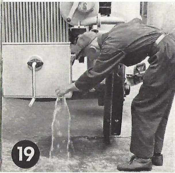
Bild 19. Bei jedem Stillsetzen der Anlage das Kondenswasser aus dem Gaskühler ablassen. Niemals bei laufendem Motor Wasserablaß öffnen!
