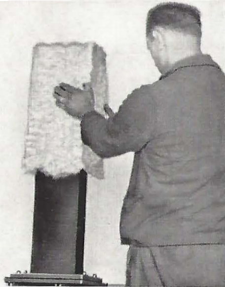
Bild 52. Der neue Glaswattebezug wird vorsichtig übergestreift, damit er sich innen und außen nicht verziehen oder etwa faltig zusammenschieben kann.
