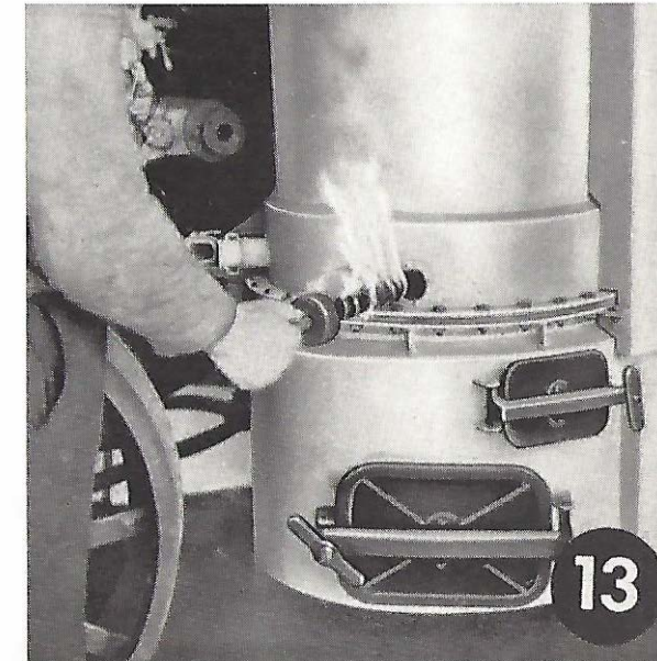
Bild 13. Die Holzkohle mit einer Fackel entzünden: gleichzeitig mit dem Gebläse oder durch den laufenden Motor den notwendigen Saugzug erzeugen.
