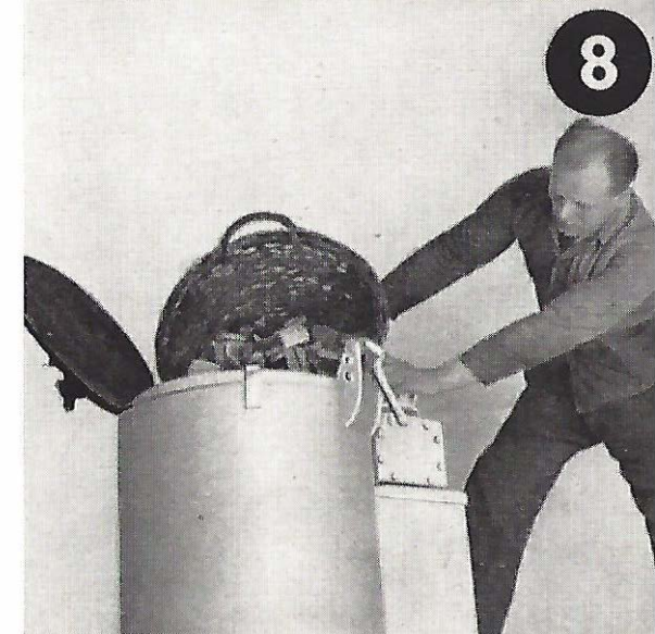
Bild 8. Nach dem Herunterstoßen der Restfüllung wird der Gaserzeuger mit Brennstoff befüllt. Holz nicht mit Gewalt in den Füllschacht stopfen!
