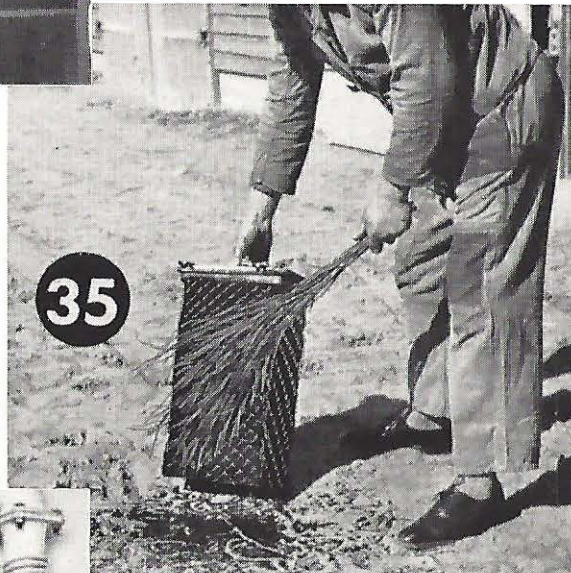
Bild 34. Nach Lösen der Deckelschrauben die Feinreinigereinsätze vorsichtig herausziehen. Bezüge nicht durch Schleifen im Gehäuse beschädigen.
