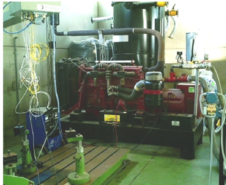
IVECO 82100 2200giri/min 40kWe
