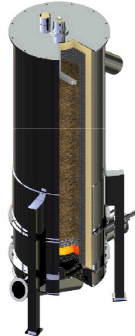
200 kW updraft gasifier
